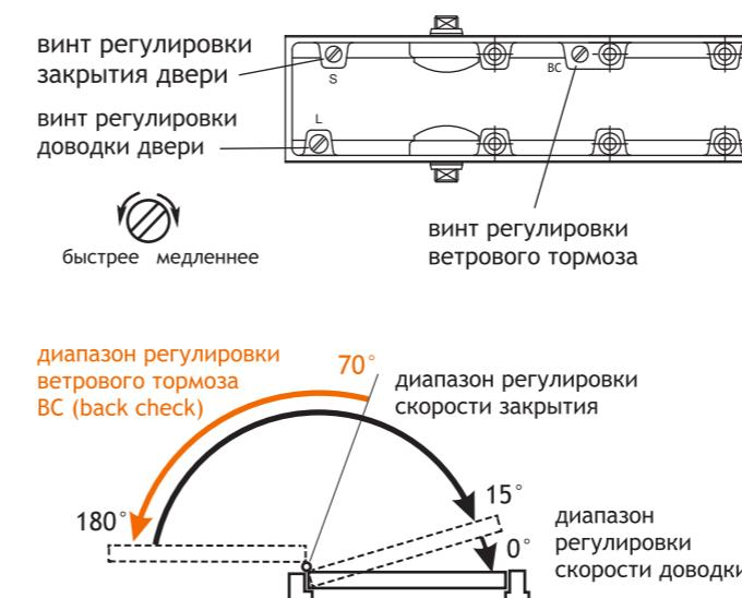
Закрытие и доводка регулируются 2 винтами. Сначала отрегулируйте скорость закрытия, далее скорость доводки двери и потом ветровой тормоз. Обозначение регулировок винтов указаны на обратной стороне доводчика
