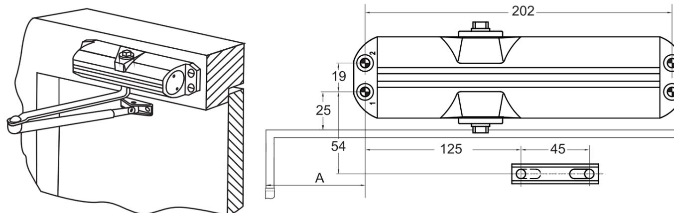
На чертеже показана дверь левого исполнения. Для двери правого исполнения используете зеркальное отображение чертежа с этими же размерами. Все размеры указаны в миллиметрах.
